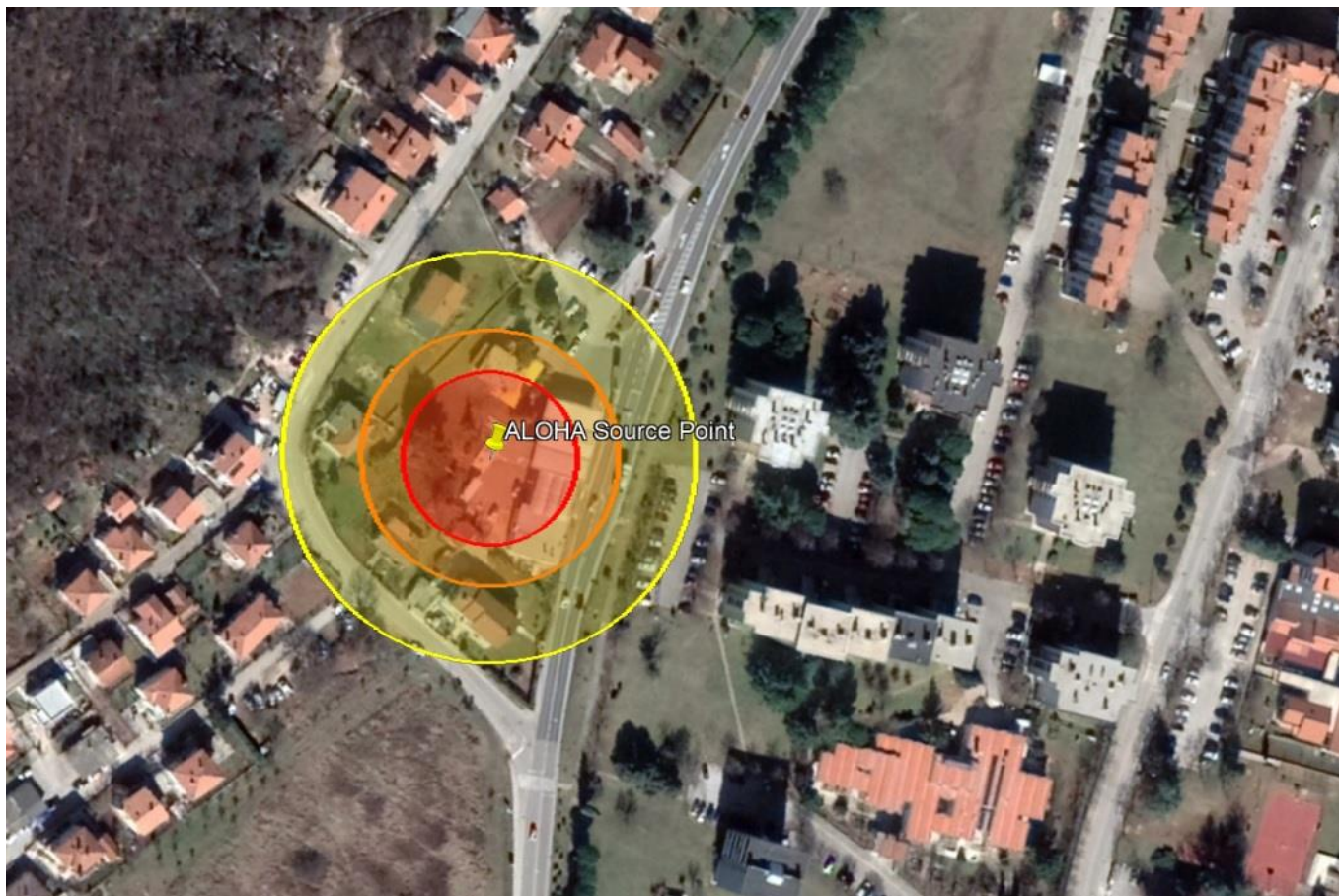
Slika 11. Zone ugroženosti požara benzina
